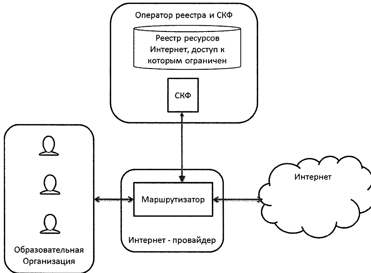
Рисунок 5. Схема работы контент-фильтрации при едином решении
